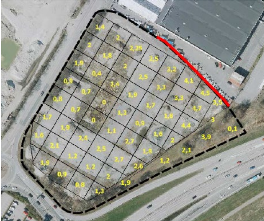
Beräknade ungefärliga genomsnittliga schaktdjup för saneringsåtgärden. Röd markering avser läge för permanent stålspont.
